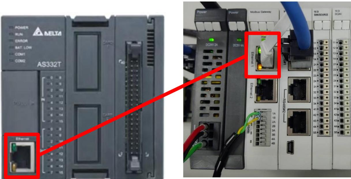
II. 閘道器第一組485Port連接至轉接模組0170-0101後再以網路線連接至控制模組
